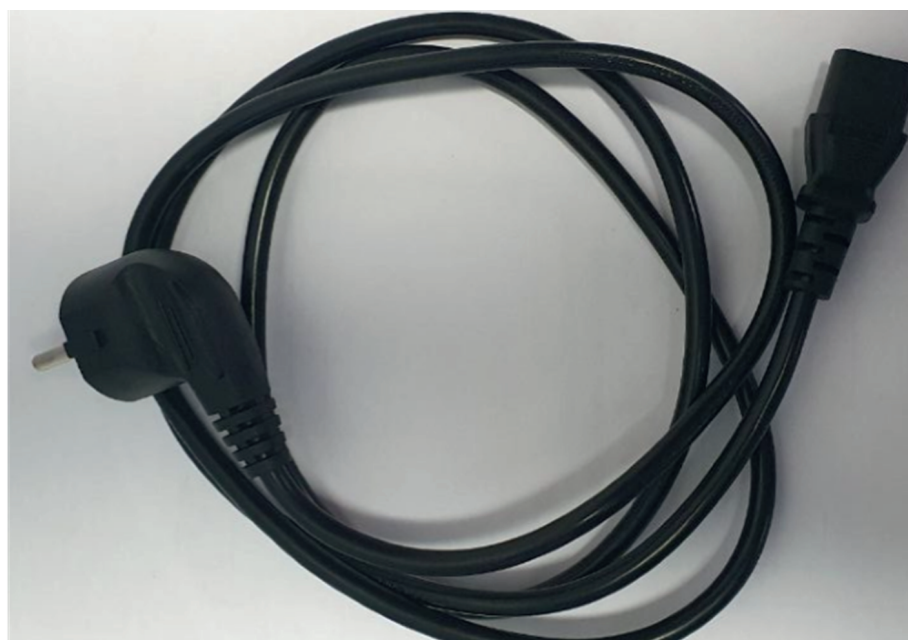
Рисунок 1.4. Кабель для подключения внешнего блока питания к сети переменного тока 220 В
