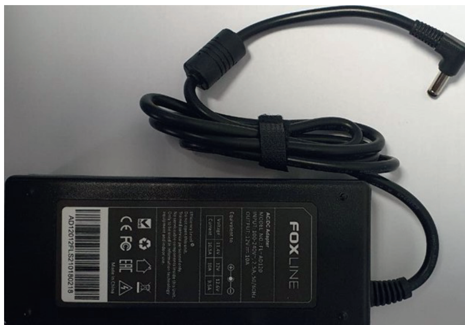
Рисунок 1.3. Внешний блок питания с кабелем для подключения к изделию
